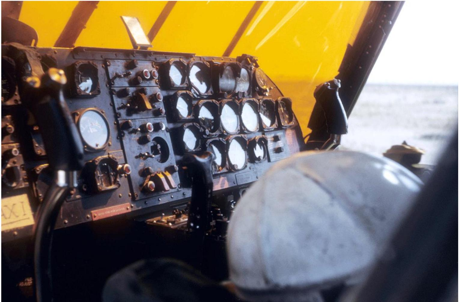
Tableau de bord d'un H-19 équipé avec des vitrages oranges pour le vol VSV. Le pilote chaussait des lunettes bleues pour se trouver dans l'obscurité. Inconvénient, les voyants rouges des alarmes devenaient alors invisibles (photo Christian Puech).
