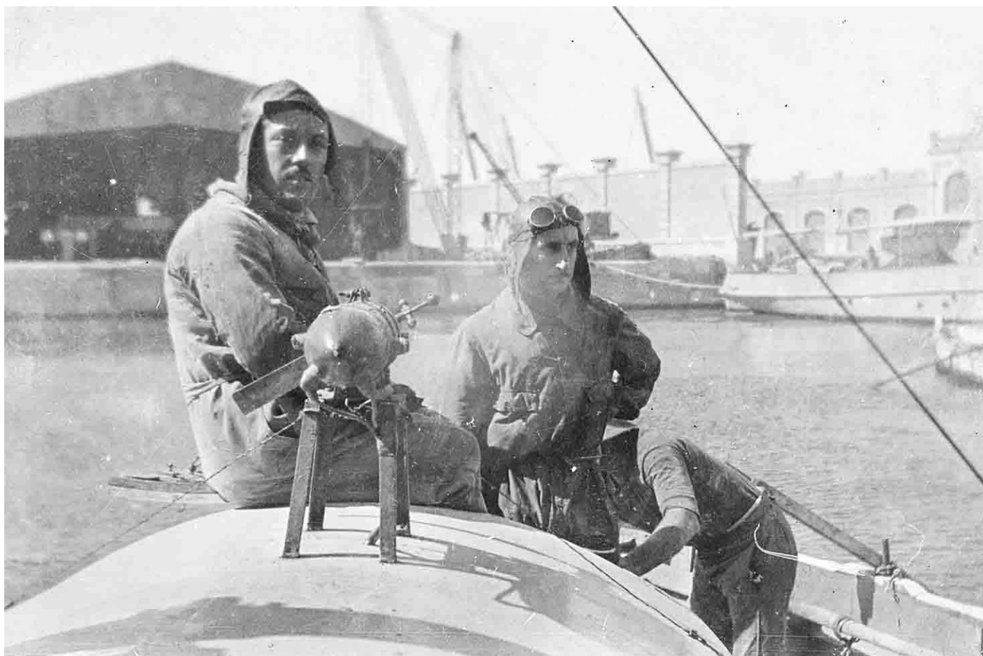
▼ Dans l'hydrobase d'Oran, sur l'avant d'un LeO H 13, Molina et Thierry. Remarquer la génératrice
