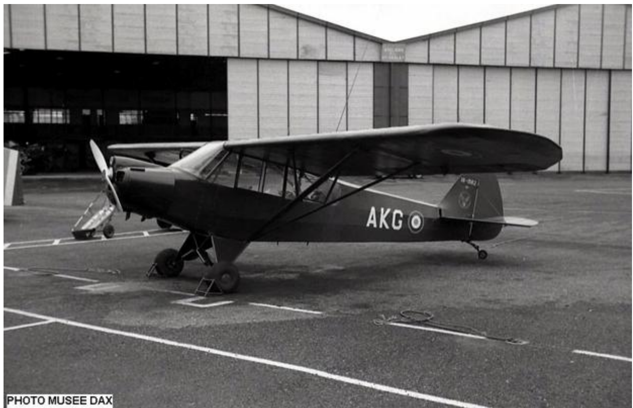
Piper L-18C n°18-1542/AKG de l'ES.ALAT, avec capot moteur modifié à cause du générateur (photo Musée de l'ALAT à Dax, via Marc Bonas).
