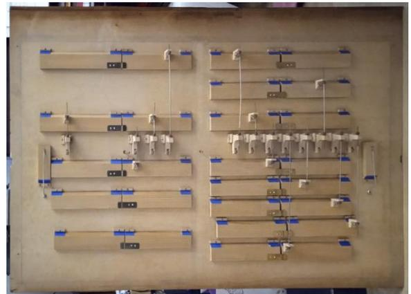
Fig. n° 18 : dessous de la table des soupapes de jeux (jeux avant en haut)
