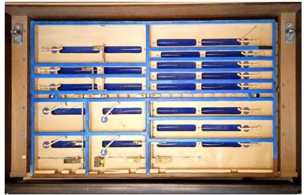
Fig. n° 17 : dessus de la table des soupapes de jeux (jeux avant en bas)
