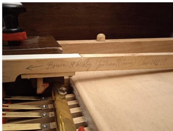
Fig. n° 23 : première touche du premier clavier et nouvelle barre de Prolongement en laiton
