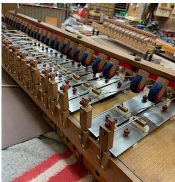
Fig. n° 27 : le célesta en cours de restauration (ici encore avec les marteaux d'origine) [cc]
