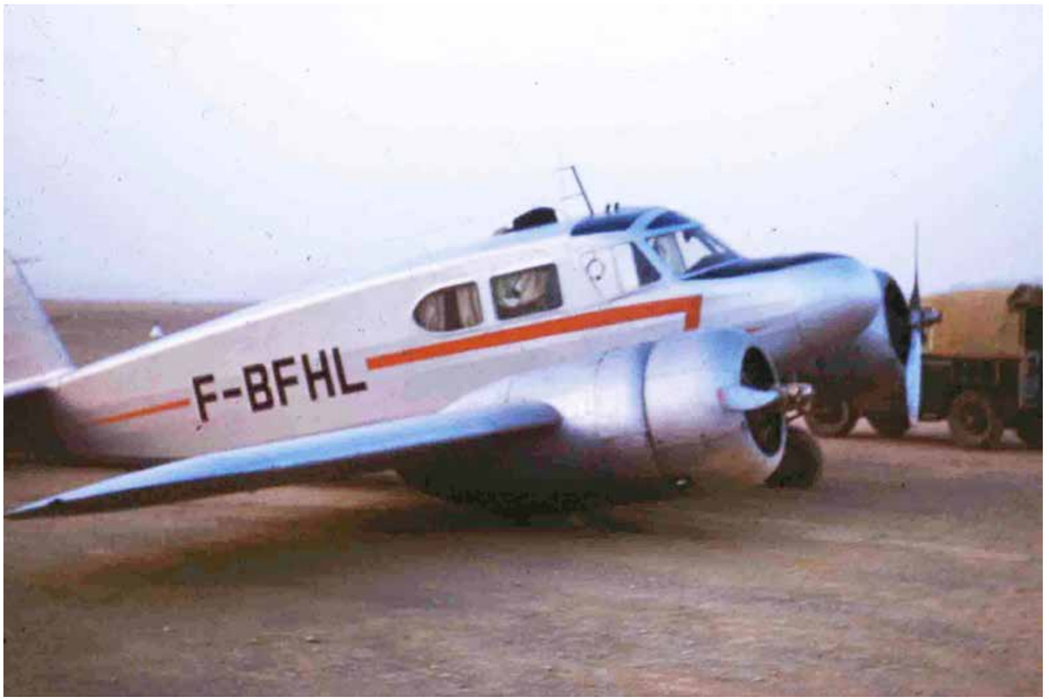
▲ ▼ Dépannage du Bobcat le 20 mai 1961. Vol Tamanrasset-Renaissance, la route droite n'est pas sortie
